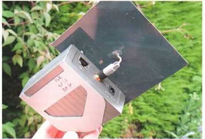
De Wireless-to-Ethernet bridge met aangesloten Biquad antenne.
